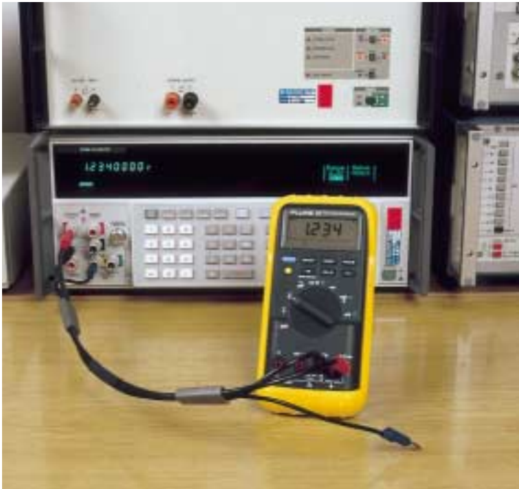
Bild 2: Kalibrierung eines Multimeters, das in einem Handwerksbetrieb eingesetzt wird
