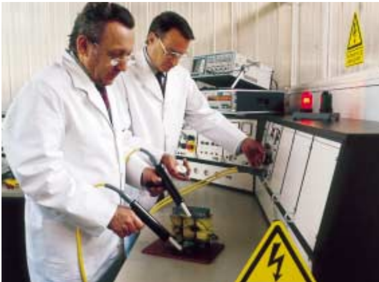
Bild 6: Prüfung von Relais-Sicherheitskombinationen und Durchführung einer Hochspannungsprüfung mit kalibrierten Messeinrichtungen
