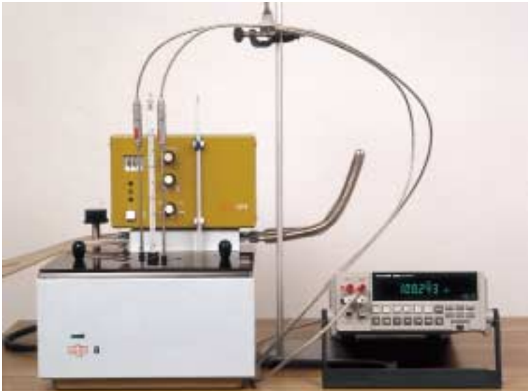
Bild 3: Kalibriereinrichtung für Temperaturmessgeräte mit Tauchfühler
