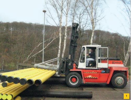
1 Der Stapler auf dem Betriebshof im Einsatz. Mithilfe des Anbaugerätes kann eine Lage Stahlrohre auf einmal transportiert werden.
