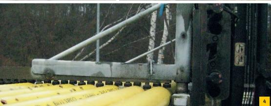
**2** Vor dem Einsatz wird das Anbaugerät am Stapler angebracht.
