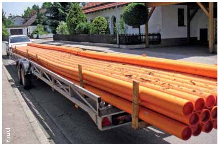
Nachläufer mit Rohrleitungen (vor Sicherung der Ladung).
