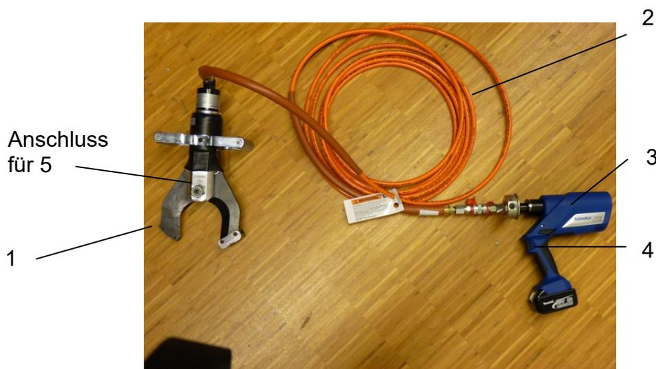
Bild 1: Beispiel eines handgeführten akkubetriebenen Kabelschneidgerätes
