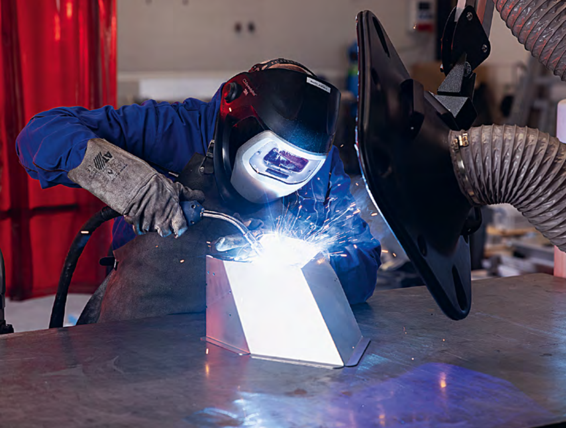
Martin Achatzi legt beim Schweißen die allgemeine Schweißerschutzrüstung an und achtet auf eine optimale Schweißrauchfassung an der Entstehungsstelle. Dazu trägt er noch einen Gehörschutz.
