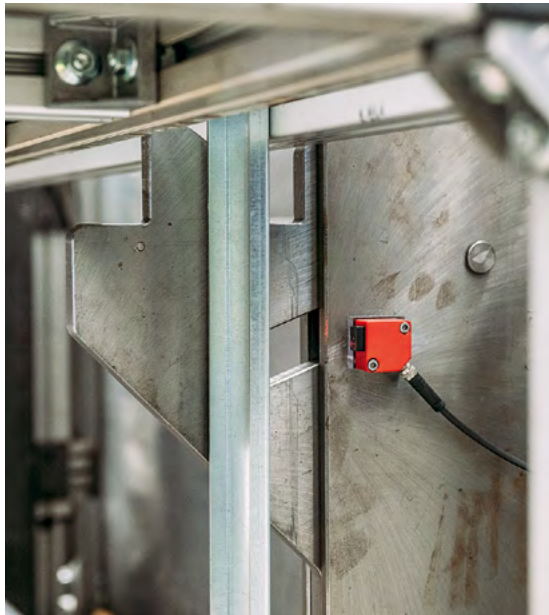
Ein Sicherheits-schalter prüft, ob der Wagen richtig steht, ehe die Greifarme ausfahren.
