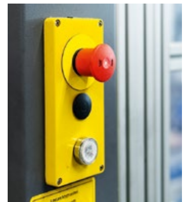
Sollte eine Schutzeinrichtung einmal nicht funktionieren, muss der Notausschalter betätigt werden.
