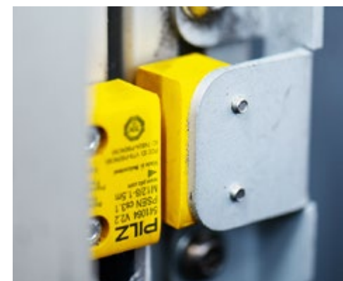
Ein Sicherheitsschloss erschwert zusätzlich, die Schutzeinrichtung der Maschine zu manipulieren.
