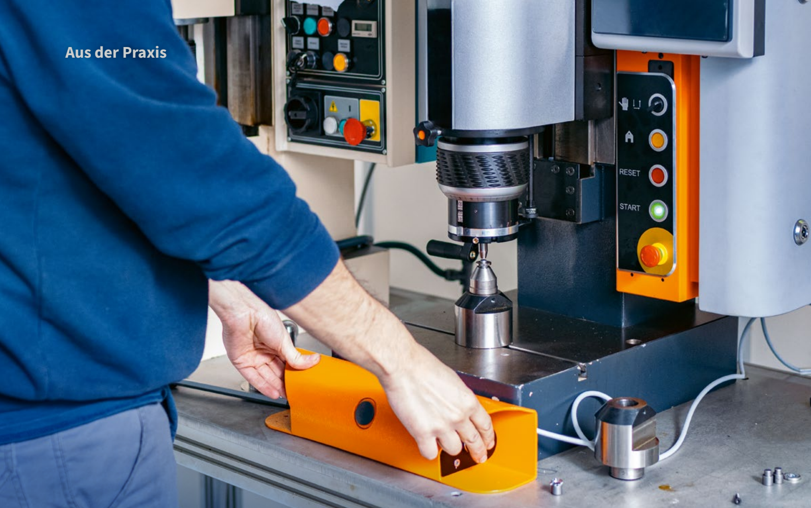
Zweihandschaltungen an Pressen verbessern die Arbeitssicherheit.
