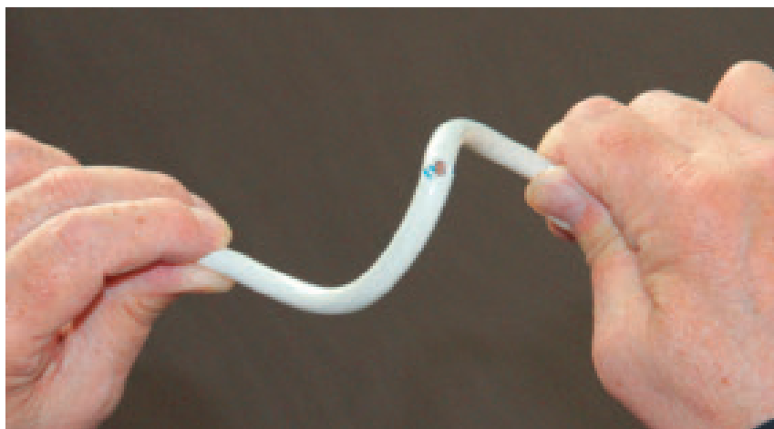
Wenn Sie feststellen, dass Betriebsmittel – also Werkzeuge, Geräte, u.a. Beschädigungen aufweisen, reicht es nicht, dieses Teil nur beiseite zu legen und als defekt zu kennzeichnen. Die Gefahr, dass der nächsten Person der Schaden nicht auffällt, ist zu groß. Beschädigte Teile sollten umgehend aus dem Verkehr gezogen werden – z.B. in einem verschlossenen Schrank aufbewahrt werden, der allen als Sammelstelle für defekte Geräte bekannt ist.
