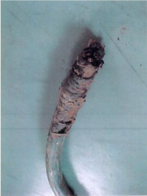
**Bild:** zerstörtes Kabelende nach dem Lichtbogenunfall
