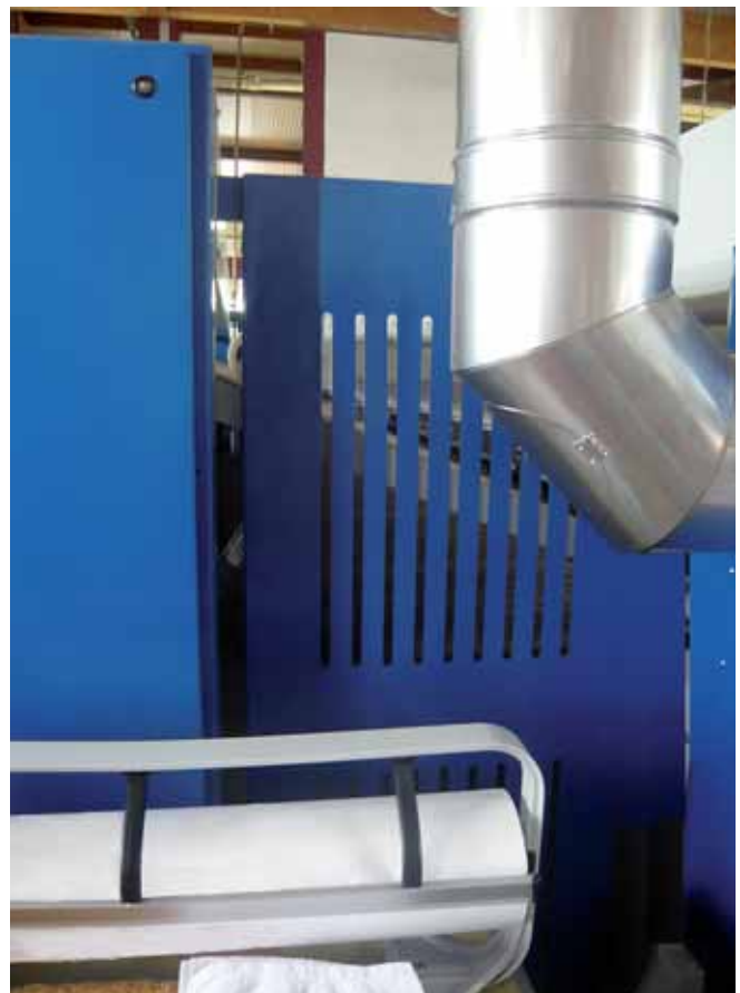
Maschinenhersteller versehen Übergänge zwischen Mangel und Faltmaschinen üblicherweise mit Gittern. Dies verhindert, dass in den Gefahrenbereich gegriffen werden kann. Fehlt das Gitter, sind Unfälle vorprogrammiert.
