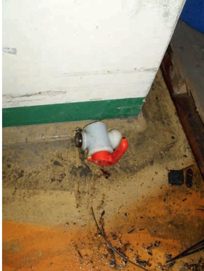
Beim Versuch, den Hahn des Schwefelsäure-Containers zu öffnen, brach der Abfüllstutzen ab und wurde etwa zwei Meter weggeschleudert.
