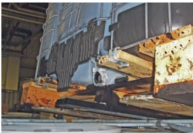
Bodenauslauf des Containers: Nachdem der Stutzen abgebrochen war, ist Schwefelsäure herausgeschossen.
