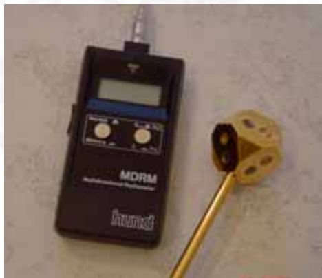
Bild 2: Delta-Radiometer (links) und Globe-Thermometer (rechts)
