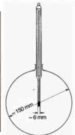
Bild 2: Delta-Radiometer (links) und Globe-Thermometer (rechts)
