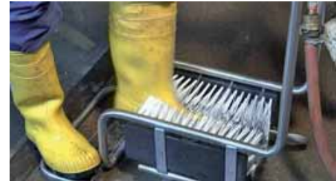
Stiefelwaschanlage im praktischen Einsatz.
