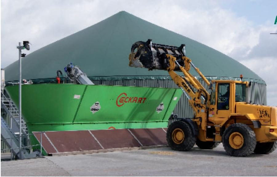
**Bild 3** Feste Zusatz- und Hilfsstoffe werden meistens auch über die Feststoffdosierung zugegeben.
