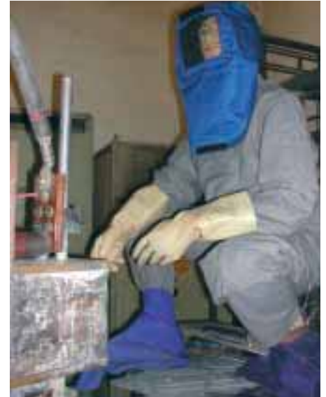
Versuchsaufbau für Arbeiten am KVS im Prüflabor der Universität Ilmenau zusammen mit dem Sächsischen Textil Forschungsinstitut in Chemnitz (Wärme-sensor im Knie)
