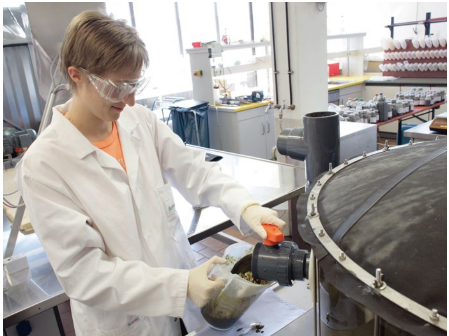
Diese Mitarbeiterin entnimmt eine Probe an einem Versuchsfermenter.
