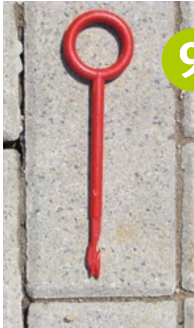
Zwickelschnur durchtrennen und entfernen (Bild zeigt Hilfswerkzeug zum Herausführen der Zwickelschnur)
