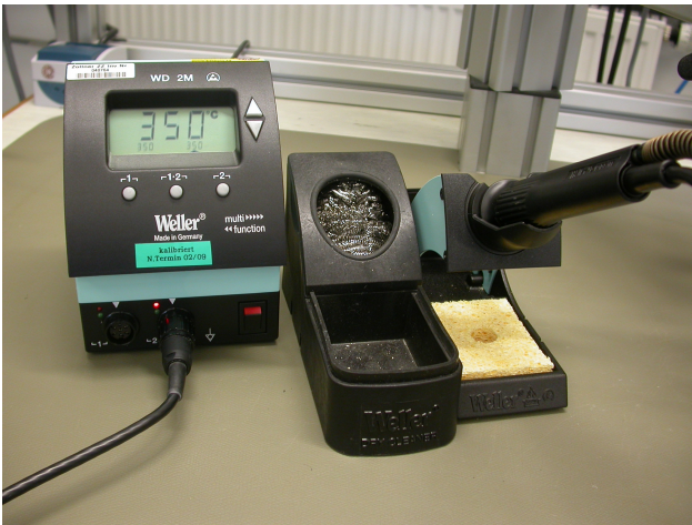
Abbildung 1: Lötstation, Lötcolben mit Halter, Lötspitze und Lötdraht
