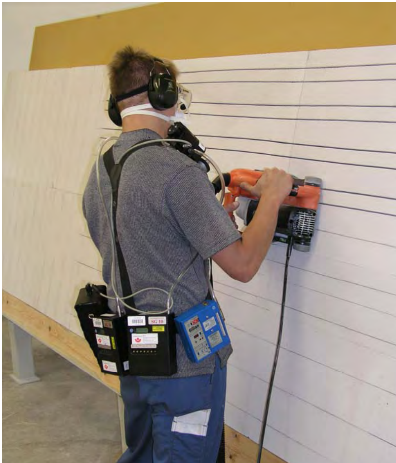
Bild 1: Einsatz einer Mauernutfräse am Prüfstand
