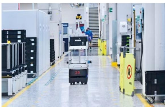
Fahrerlose Transportsysteme surren durch die Fabrik. Sie transportieren Material und Waren von einer Arbeitsstation zur anderen.
