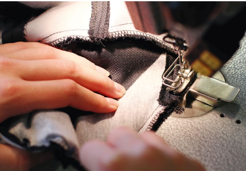
Der Fingerabweiser verhindert Stichverletzungen und Fingerdurchnähenen.
