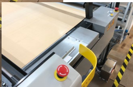
Die Abdeckung des Zahnriemens im Normalbetrieb.
