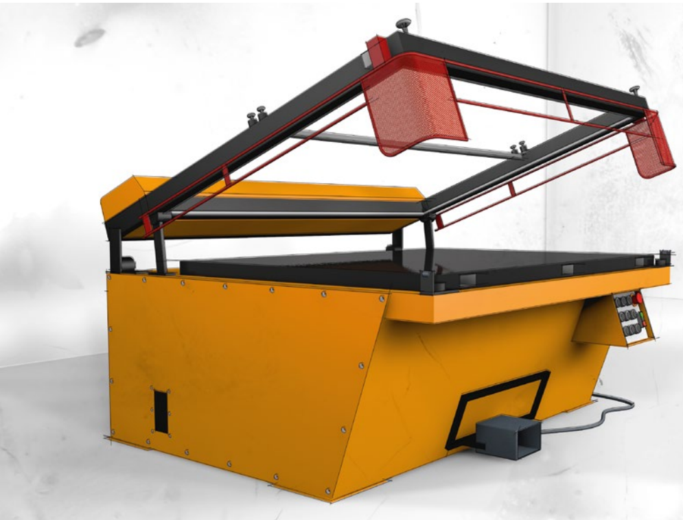
Schema einer winkel- öffnenden Siebdruck- maschine (Halbauto- mat), an der der Unfall verursacht wurde.
