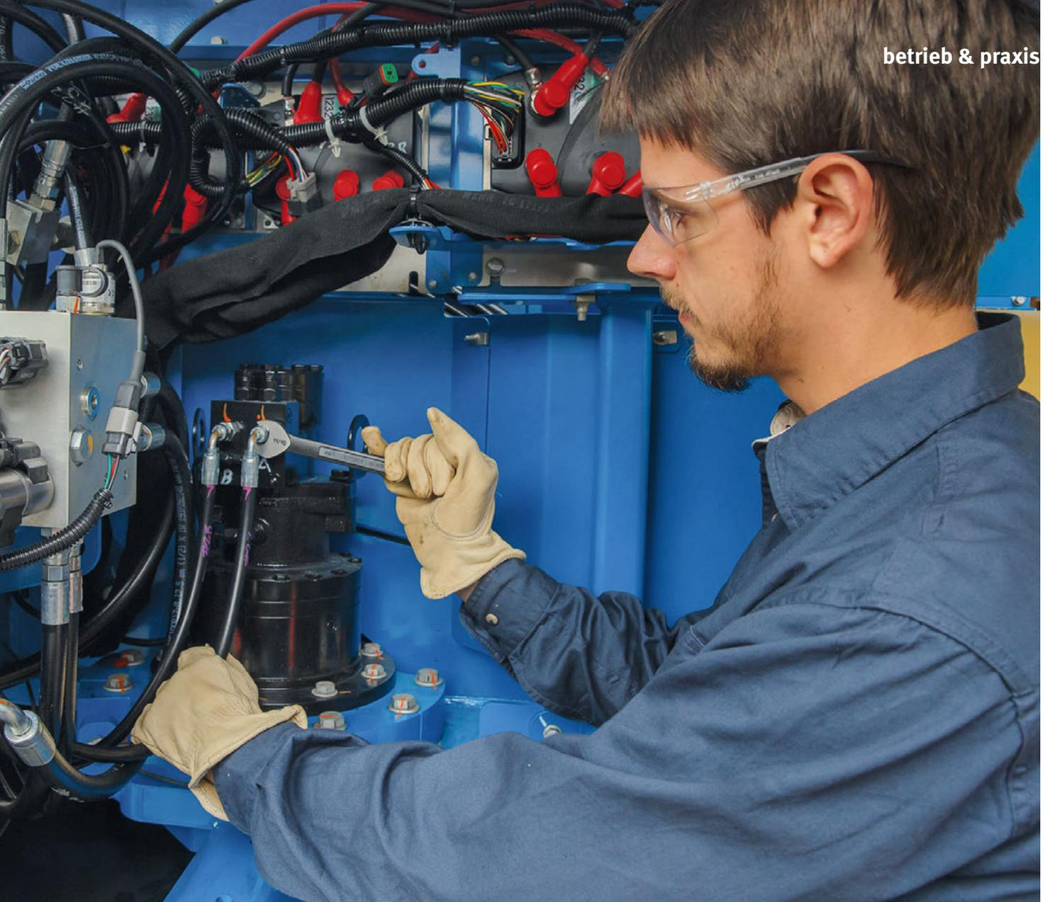
Bei der Instandhaltung von Hydraulikanlagen kann Hydrauliköl unter hohem Druck austreten.
