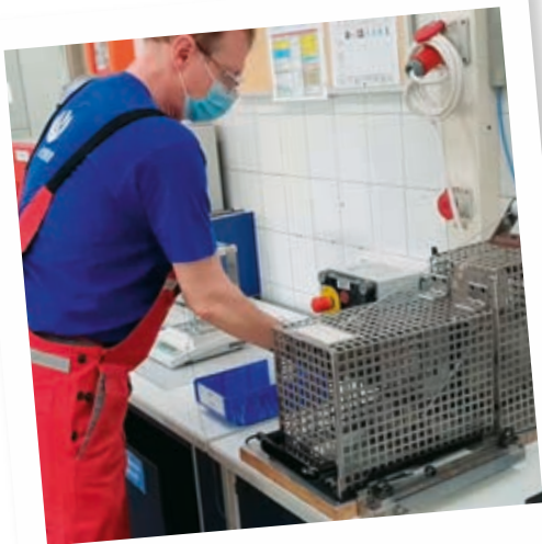
Geräte wurden speziell für Peter Friedl umgebaut, schlecht zu greifende Flügelschrauben durch Bügel ersetzt.
