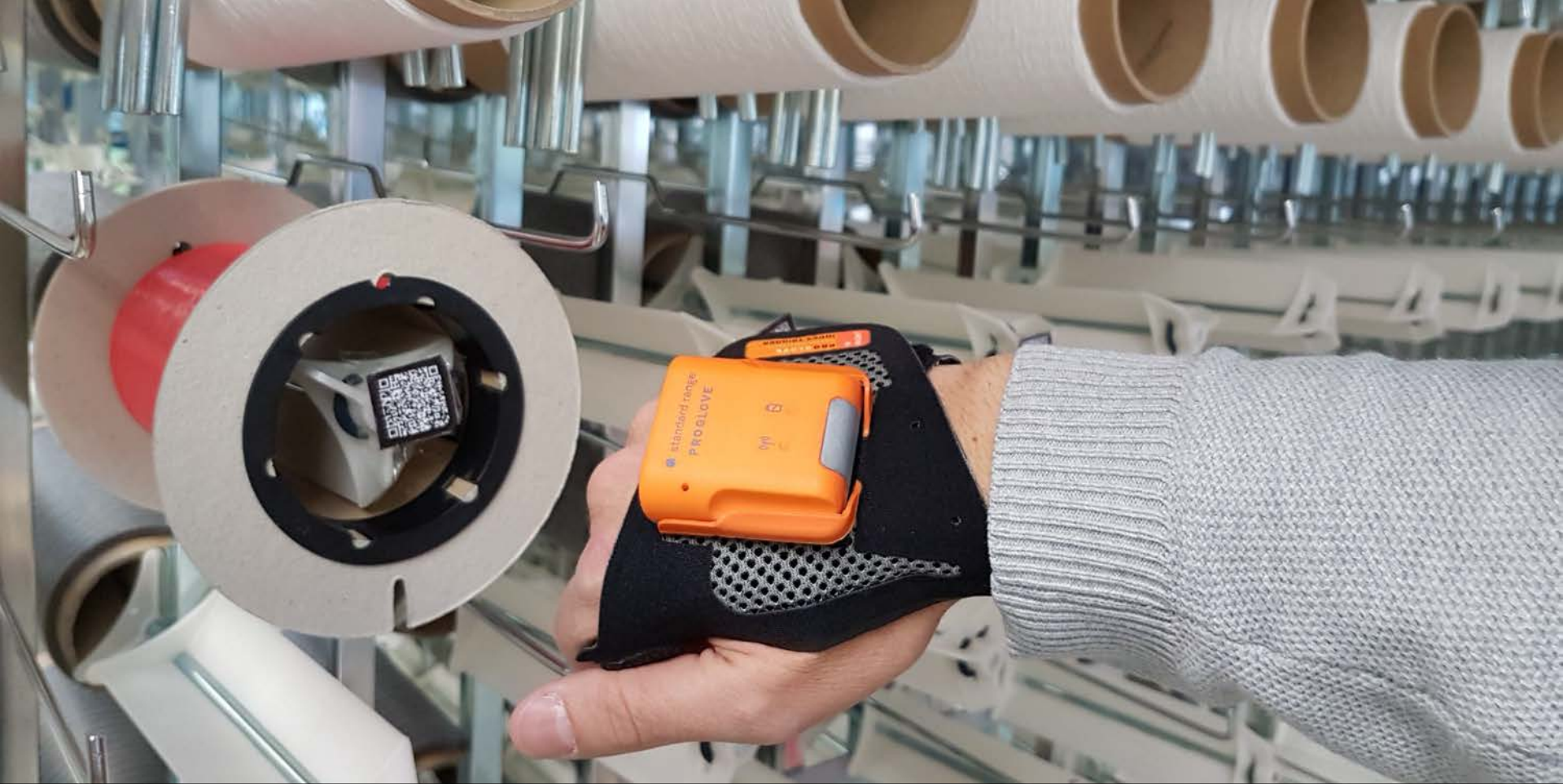
Manuelle assistierte Spulengatter-Bestückung an der Webmaschine
