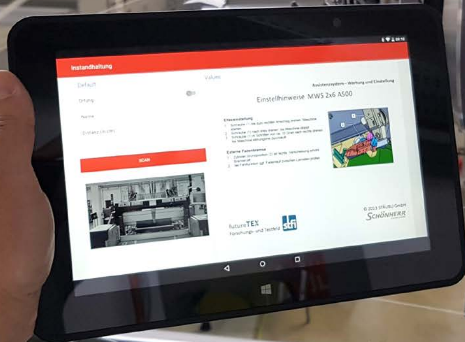
Assistenzsystem Komponenteneinstellungen an der Webmaschine
