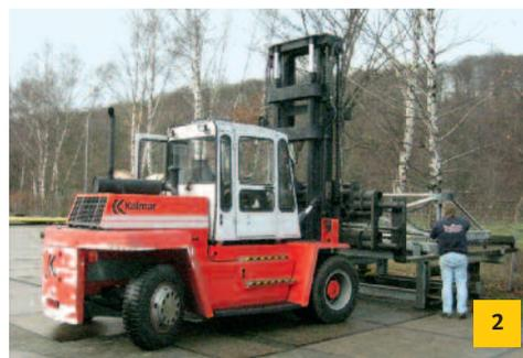
2 Vor dem Einsatz wird das Anbaugerät am Stapler angebracht.
