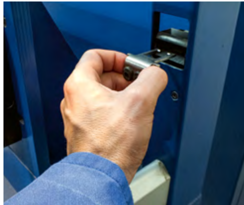
Manipulation: Ersatzbetätigter überbrücken und setzen die Schutztür außer Kraft.
